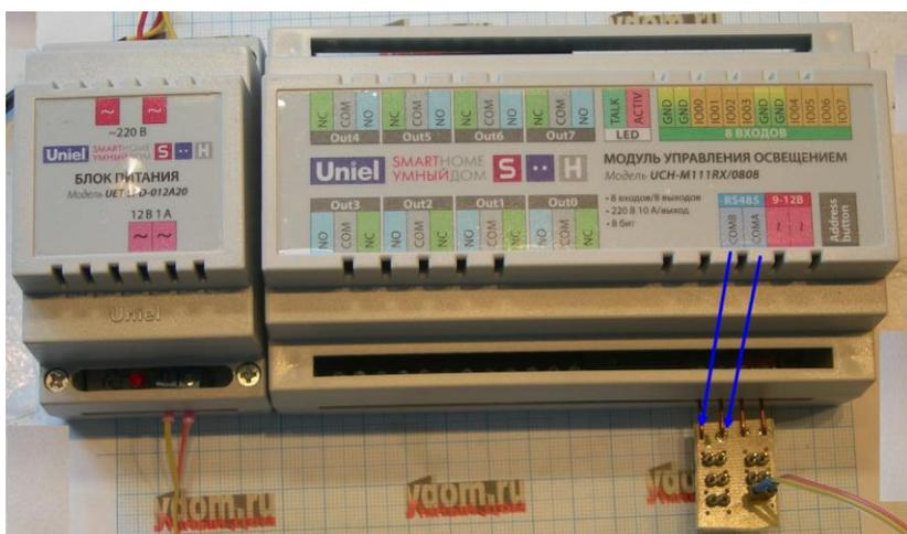
Рис. 2 Модуль управления светом и блок питания модуля. Синими стрелками показаны контакты для подключение проводов А и В шины RS-485.
